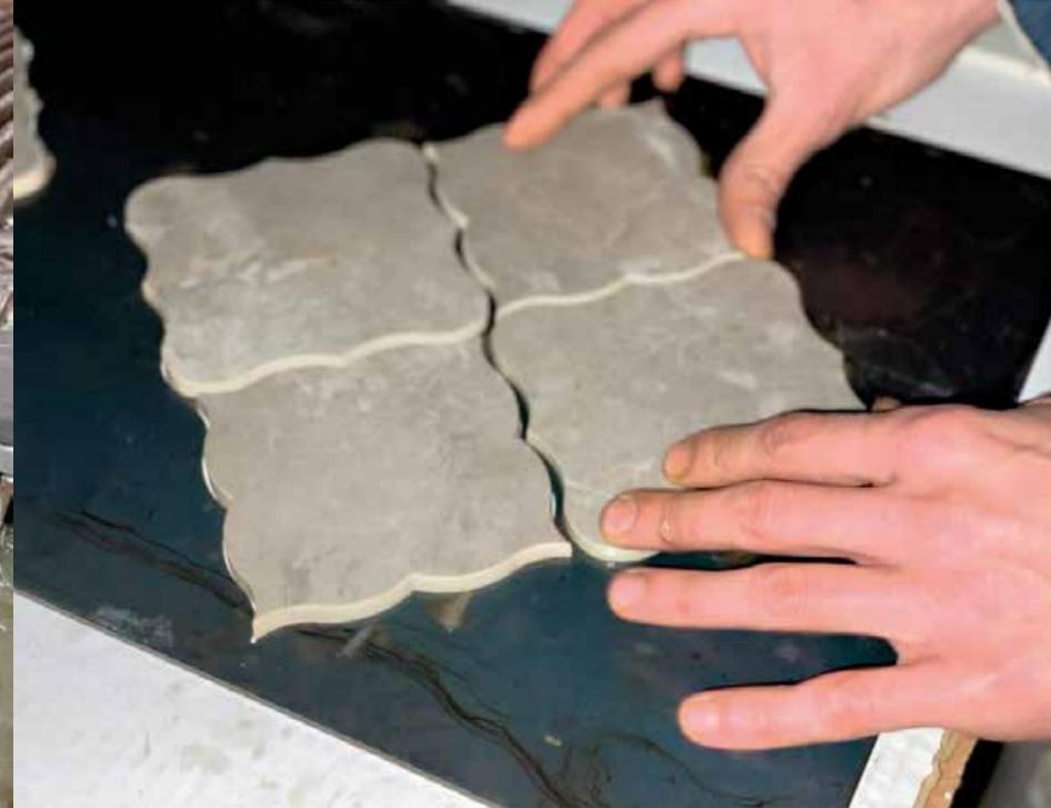
Progettare e dare spazio alle idee più creative, arredare in modo non usuale e con stile, grazie alla nostra macchina da taglio a getto d'acqua con la testina basculante, siamo in grado di ricavare da una lastra o da una piastrella di gres porcellanato qualsiasi forma.
