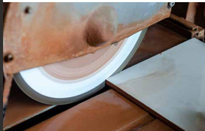
Sezioniamo e rettifichiamo lastre ceramiche di qualsiasi spessore in sottoformati commerciali, fino ai massimi formati commercializzati (160x320 cm) e con qualunque tipo di finitura superficiale.
